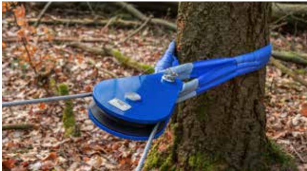
Berufsgenossenschaftliche Informationen für Sicherheit und Gesundheit bei der Arbeit Abb. 17 Gefahrbereich - Seilinnenwinkel - bei umgelenktem Zug
