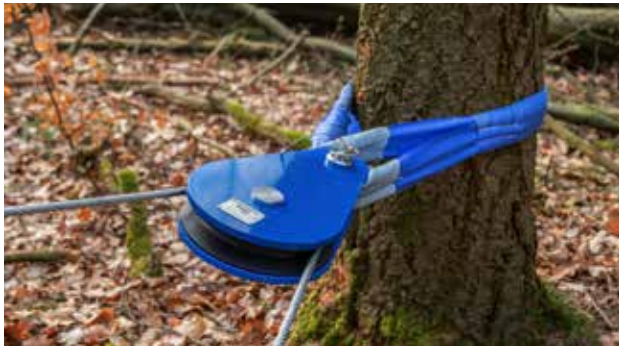
Berufsgenossenschaftliche Informationen für Sicherheit und Gesundheit bei der Arbeit Abb. 17 Gefahrenbereich - Seilinnenwinkel - bei umgelenktem Zug
